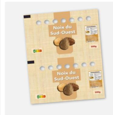
**Macro perforation**: trous repérés, ouverture facile, perforation de forme, aiguille chaude
